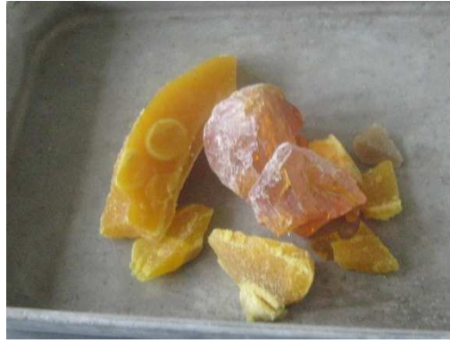
Figura 17 – Isolante pez louro e cera de abelha
