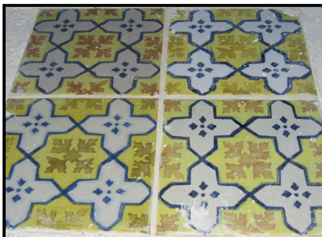
Figura 78: Aspecto final de azulejos com espaçamento de junta 3 mm
