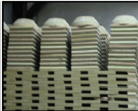
Figura 11: Disposição dos azulejos no forno
