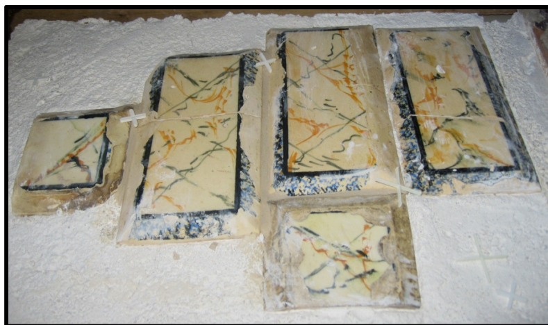
Figura 81: Aspecto final de azulejos de relevo com espaçamento de junta 1, 2, 3 mm
