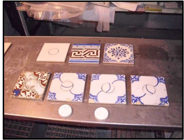
Figura 39. Corte dos azulejos utilizados no trabalho
