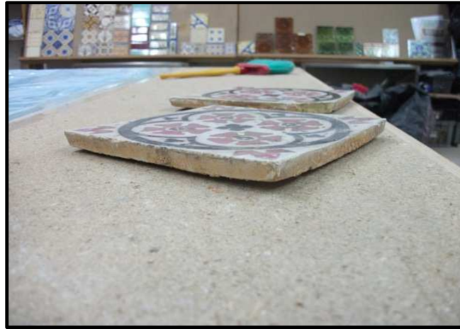
Figura 18. Azulejo com defeito de fabrico apresentado empeno
