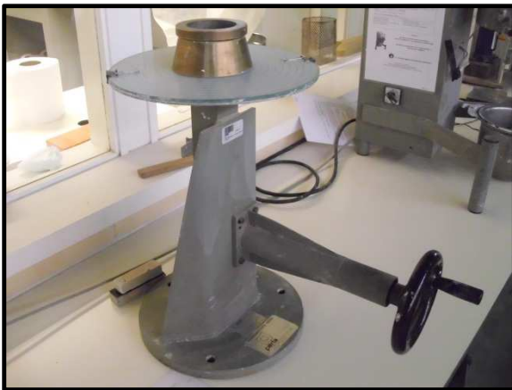
Figura 56. Equipamento utilizado no ensaio de espalhamento
