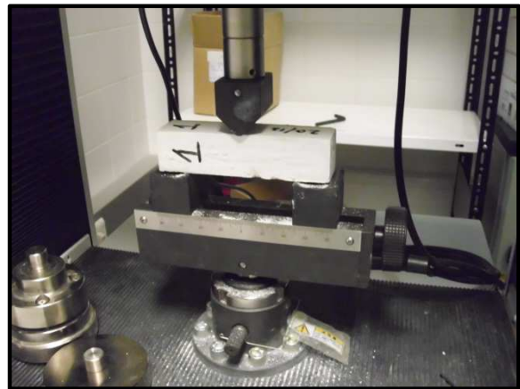
Figura 61. Provete da argamassa um aos 60 dias, a ser ensaiado à tração por flexão
