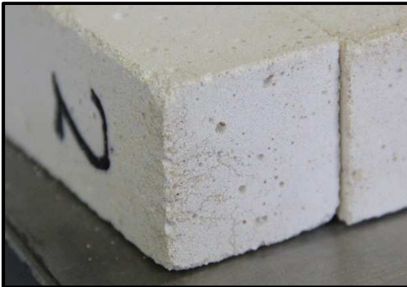
Figura 75. Pormenor dos provetes de argamassa dois após ensaio de envelhecimento
