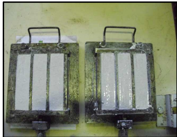
Figura 45. Moldes de provetes prismáticos com argamassas frescas
