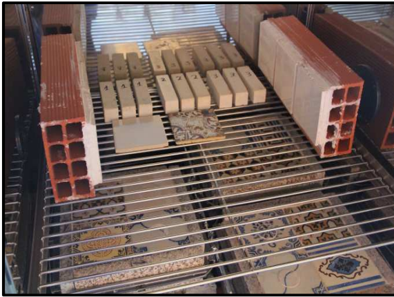
Figura 51. Câmara climática com carregamento dos sistemas da prateleira superior
