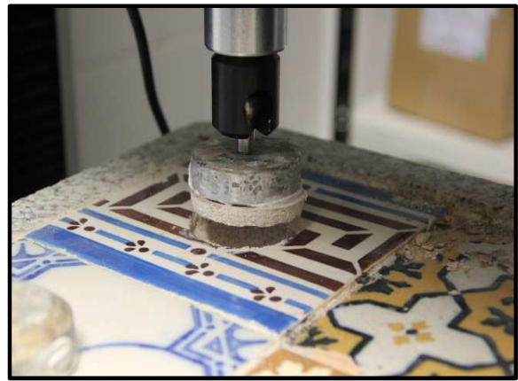
Figura 71. Seção circular do azulejo com pastilha metálica resultante do ensaio de arrancamento por tração no sistema três – azulejo réplica
