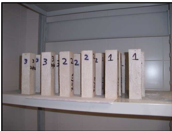
Figura 53. Cura de prismas na câmara climática 20 °C e 65 % HR
