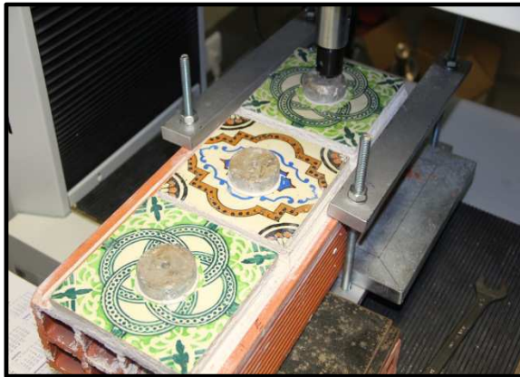
Figura 95. Arrancamento por tração no sistema vertical – argamassa um com azulejo original
