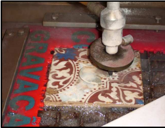
Figura 38. Corte circular em azulejo através de máquina de jacto água de corte abrasivo
