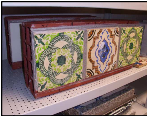
Figura 44. Sistema vertical com assentamento de azulejos originais
