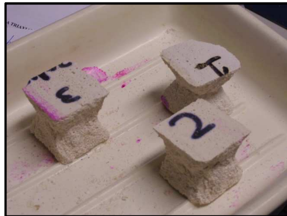
Figura 63. Prismas resultantes do ensaio de resistência à compressão das argamassas sujeitas à câmara climática
