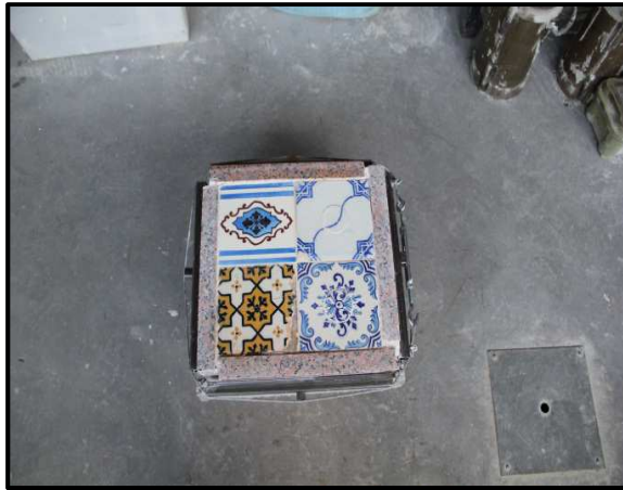
Figura 49. Sistemas (2 réplicas x 2 originais) com argamassa 2
