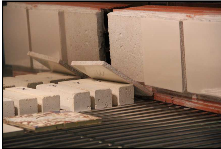
Figura 72. Pormenor do sistema um vertical com réplicas, onde é possível visualizar o destacamento de um azulejo assente com a argamassa um ao oitavo ciclo de envelhecimento.
