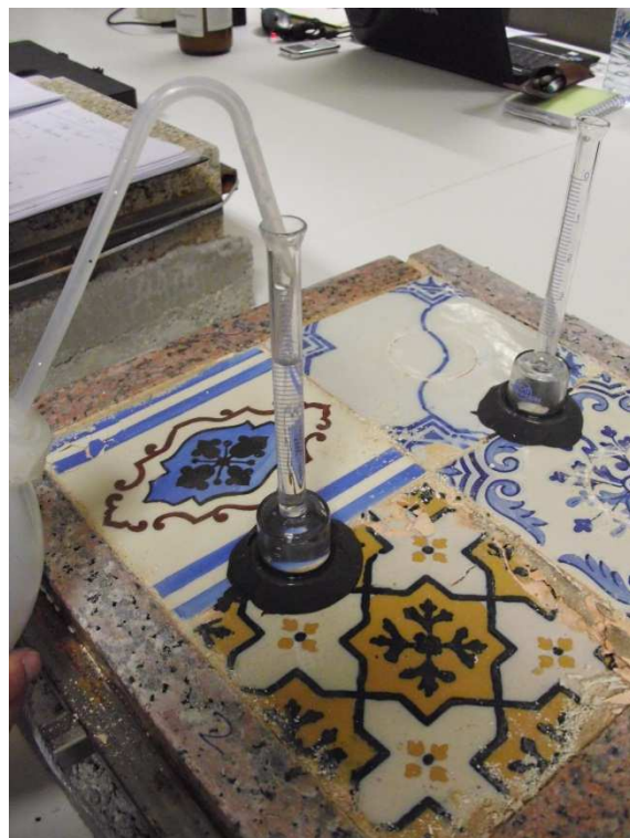
Figura 67. Ensaio de aplicação dos tubos de Karsten no sistema 2 sujeitos às condições da câmara climática aos 90 dias.
