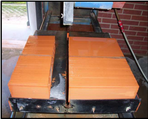
Figura 40. Corte dos tijolos cerâmicos
