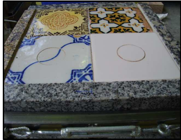
Figura 43. Sistema um final com aplicação de quatro azulejos – duas réplicas e dois originais
