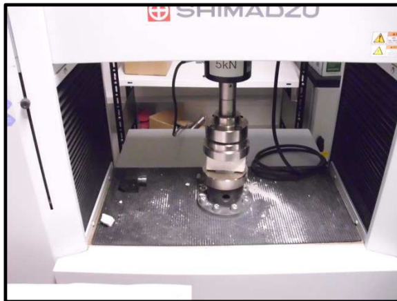
Figura 62. Ensaio de resistência à compressão
