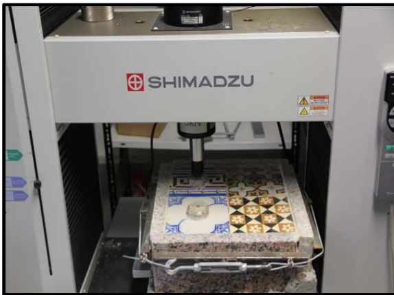
Figura 70. Equipamento utilizado no ensaio de arrancamento por tração
