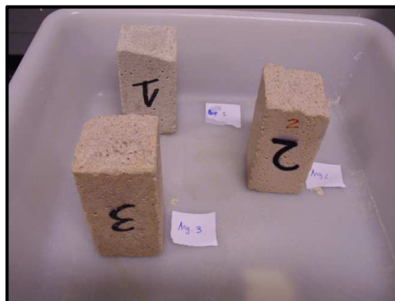
Figura 65. Secagem das amostras das argamassas sujeitos à câmara climática aos 90 dias
