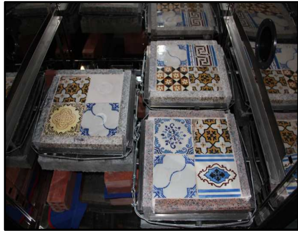
Figura 50. Câmara climática com carregamento dos 3 sistemas na prateleira inferior
