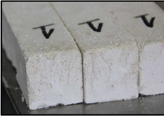
Figura 73. Pormenor dos provetes de argamassa um após ensaio de envelhecimento
