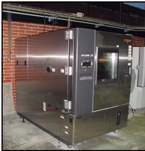
Figura 48. Câmara de Ensaio Climáticos ESPEC ARL-680
