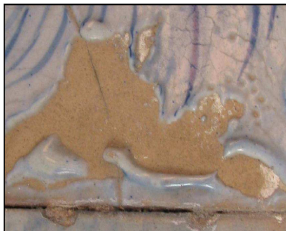
Figura 13. Pormenor de enrolamento característico da camada de vidro (MIMOSO, 2011b)
