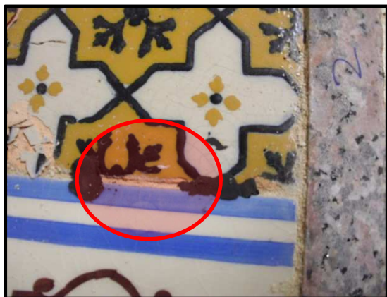
Figura 68. Exemplo de junta de zona Z1 onde foi efetuado o ensaio de absorção de água sob baixa pressão, sistema dois
