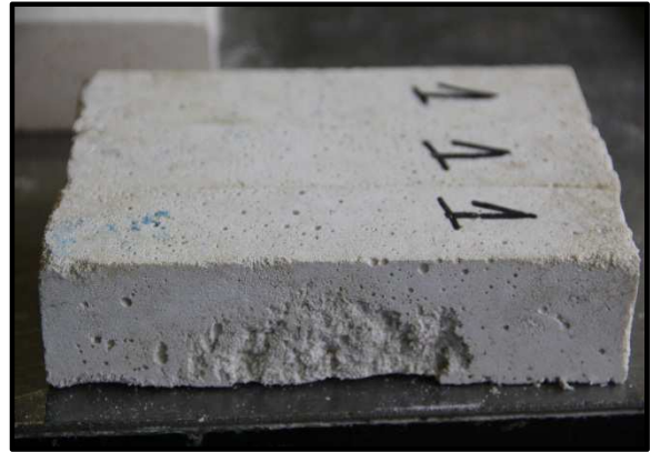
Figura 74. Pormenor dos provetes de argamassa um após ensaio de envelhecimento, vista lateral
