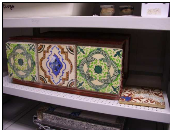
Figura 54. Cura dos sistemas verticais e horizontais na câmara climática 20 °C e 65 % HR
