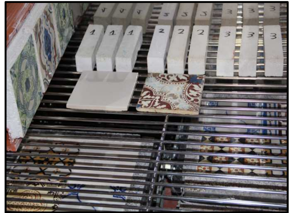
Figura 52. Pormenor da Câmara climática com carregamento dos sistemas da prateleira superior
