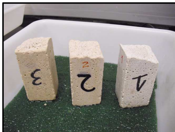
Figura 64. Ensaio de absorção por capilaridade das argamassas sujeitos à câmara climática aos 90 dias
