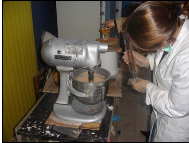
Fig. 56 - Colocação de água na mistura
