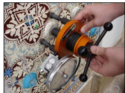
Fig. 39 - Arrancamento da carote.
