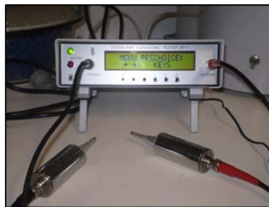
Fig. 25 - Máquina de ensaios para a determinação do módulo de Elasticidade (E) pelo método dos ultra-sons
