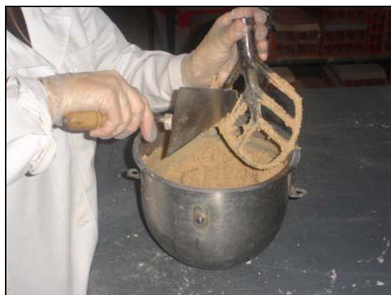
Fig. 58 - Limpeza da face interna da cuba
