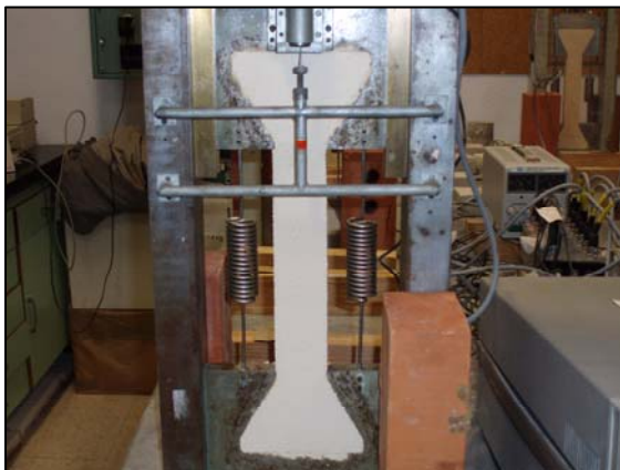
Fig. 37 - Ensaio de susceptibilidade à fendilhação
