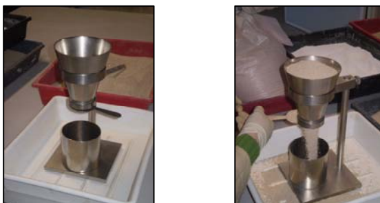
Fig. 30 - Aparelho para a determinação experimental da massa volúmica aparente
