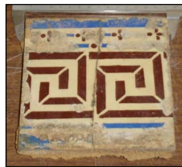
Fig. 23 - Fissuração e descamação do vidrado
