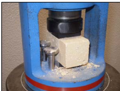
Fig. 36 - Prisma a ser ensaiado à compressão
