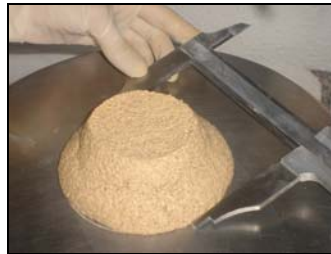
Fig. 31 - Molde cónico com argamassa
