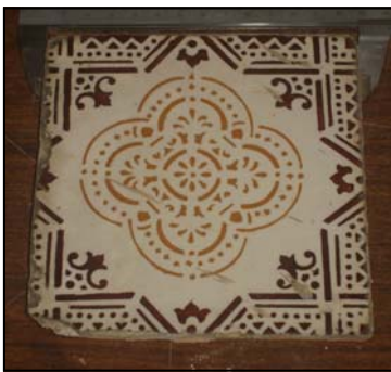
Fig. 22 - Caso de desgaste e riscagem
