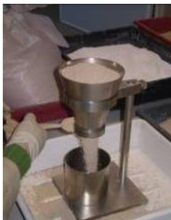
Figura 24 – Determinação da massa volúmica aparente.
