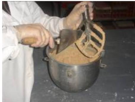
**Figura 51** – Junção da argamassa não associada
