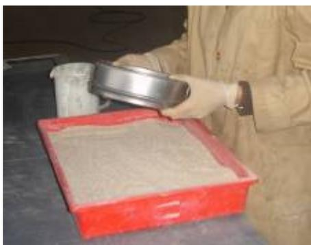
**Figura 49** – Peneiração de areia de rio com peneiro n.º 10 (ASTM)
