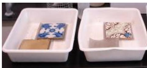
**Figura 22** – Tabuleiros com amostras imersas em água para o ensaio de absorção de água por capilaridade
