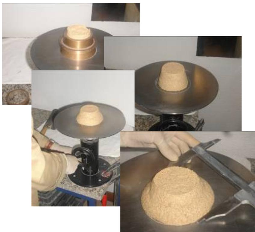
**Figura 25** – Procedimento do ensaio de consistência por espalhamento.
