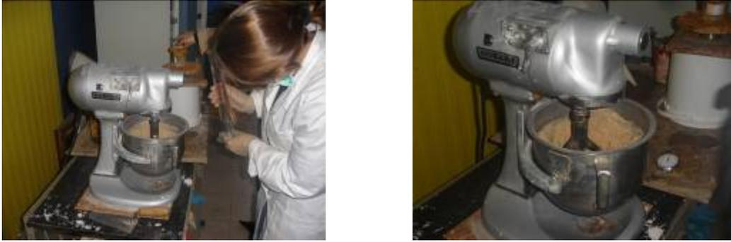
**Figura 50** – Adição de água e homogeneização da mistura de argamassa
