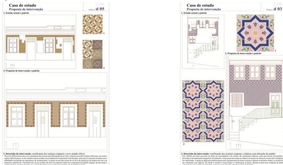
Figs. 8 e 9 - Propostas de solução de para intervenção em edifícios antigos com falhas relevantes no respetivos panos.
