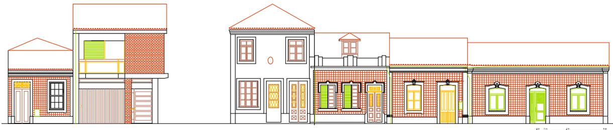
Fig. 1 - Representação do alçado este da Rua Dr. José Falcão (Ovar), com a introdução de um novo edifício (segundo da esquerda) e de alterações, como a substituição de caixilharias (três prédios da direita).
