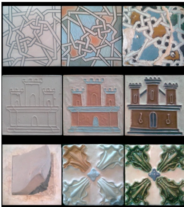
Fig 27 Métodos de execução de corda seca, aresta e relevo – Museu Nacional do Azulejo
