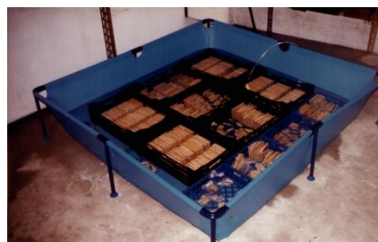
Fig. 21 – Processo de dessalinização de azulejos (Fonte: ACRA)
